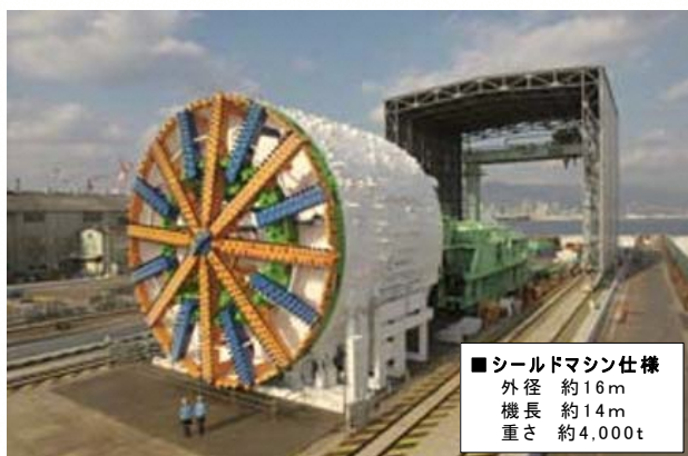
大泉発進の本線トンネルシールドマシン
