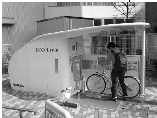
近年整備された地下式駐輪場
