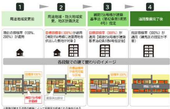
都市計画・道路整備の段階における容積率のイメージ
