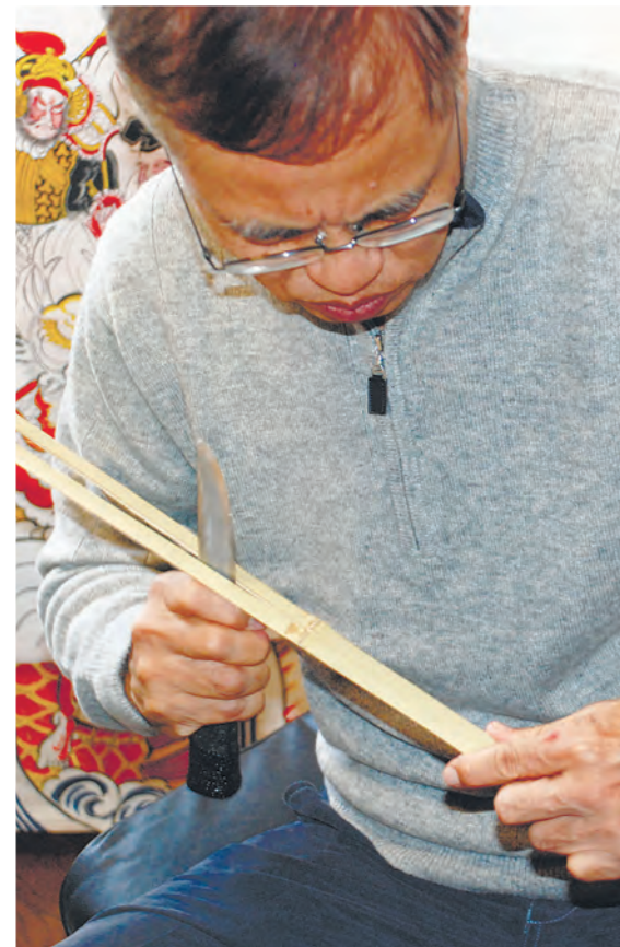
真竹(まだけ)を一年以上乾燥させ、軽くて弾力性のある凧の骨を作ります。竹を割る際は、骨の太さが左右均等になるよう注意しながら、小刀を入れます。
