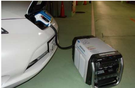
電気自動車に接続した外部給電機器
