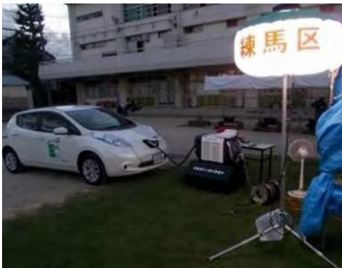
EVによる給電の様子
