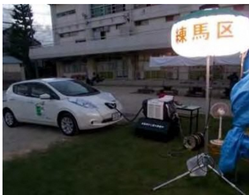
EVによる給電の様子
