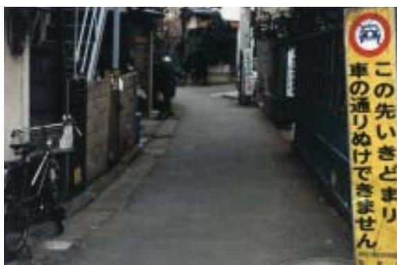
写真1 車が通り抜けのできない4メートル未満の道路。火災の延焼、避難路の安全、緊急車両の進入困難など災害時の心配があります。
