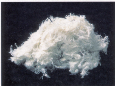
白石綿（クリソタイル）
