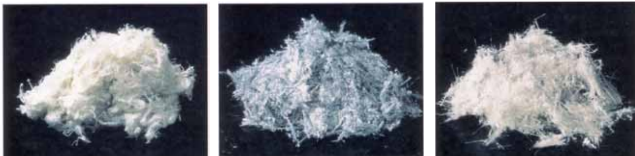
白石綿（クリソタイル）
