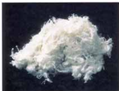
白石綿（クリソタイル）
