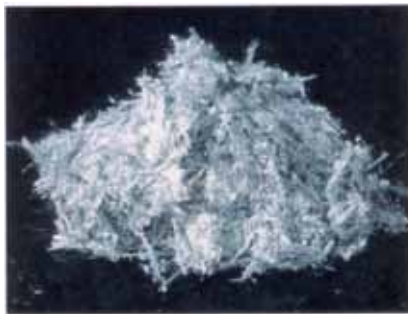
青石綿（クロシドライト）
