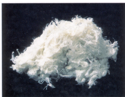
白石綿（クリソタイル）
