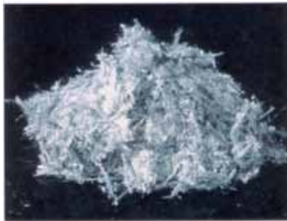
青石綿（クロシドライト）
