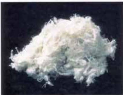
白石綿（クリソタイル）
