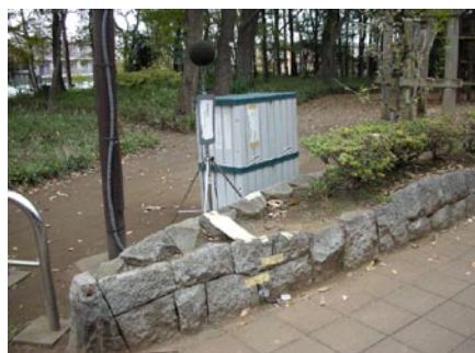
写真1 道路騒音、振動測定の様子
