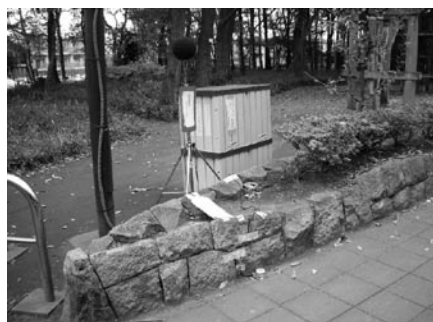
写真1 道路騒音、振動測定の様子
