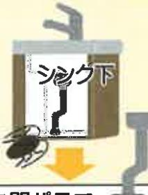
すき間パテで、シンク下の排水管のすき間を埋める。
