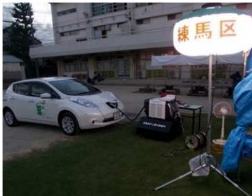
EVによる給電の様子
