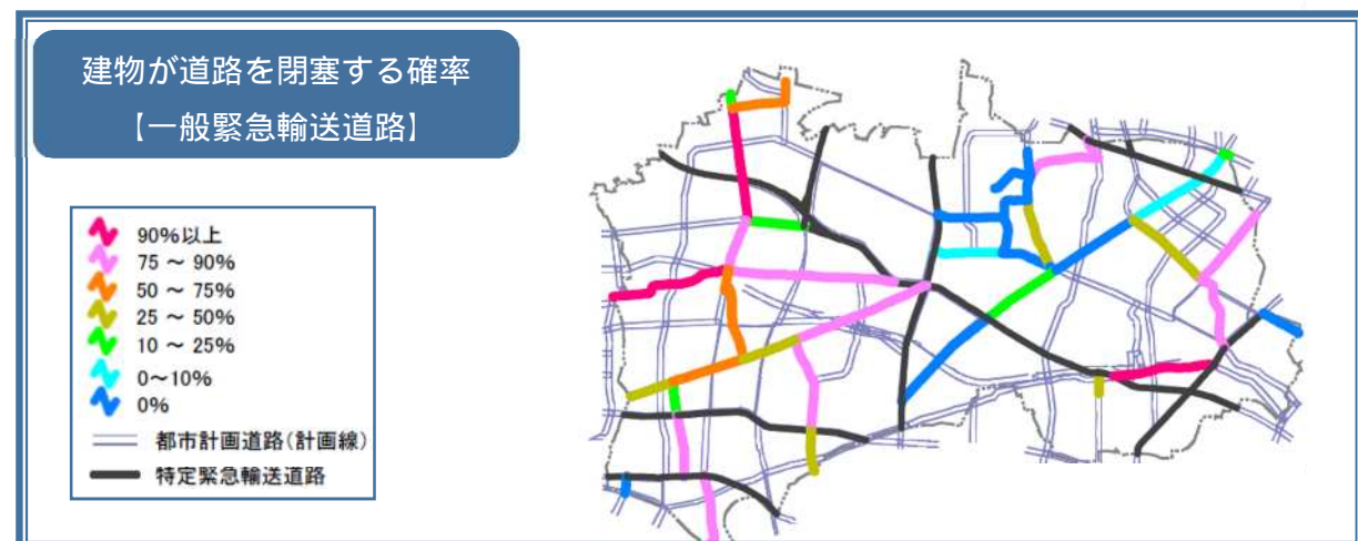
図4-5 区内全域で震度6強の揺れがあった場合の一般緊急輸送道路沿道建築物の閉塞する確率
