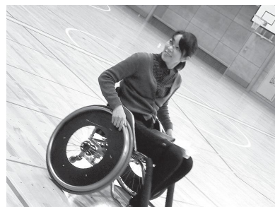
スポーツ車いすは、タイヤがハの字になっているので高速ターンをしても転倒しにくい
