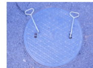
マンホール開閉用手錠
