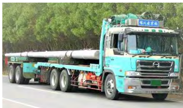
杭材搬送トレーラー(参考)
