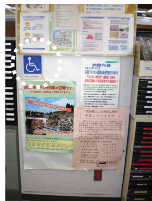
車いす使用者用トイレの方向を示す誘導サインの例。周囲の掲示物が多いため、気づきにくくなっている。
