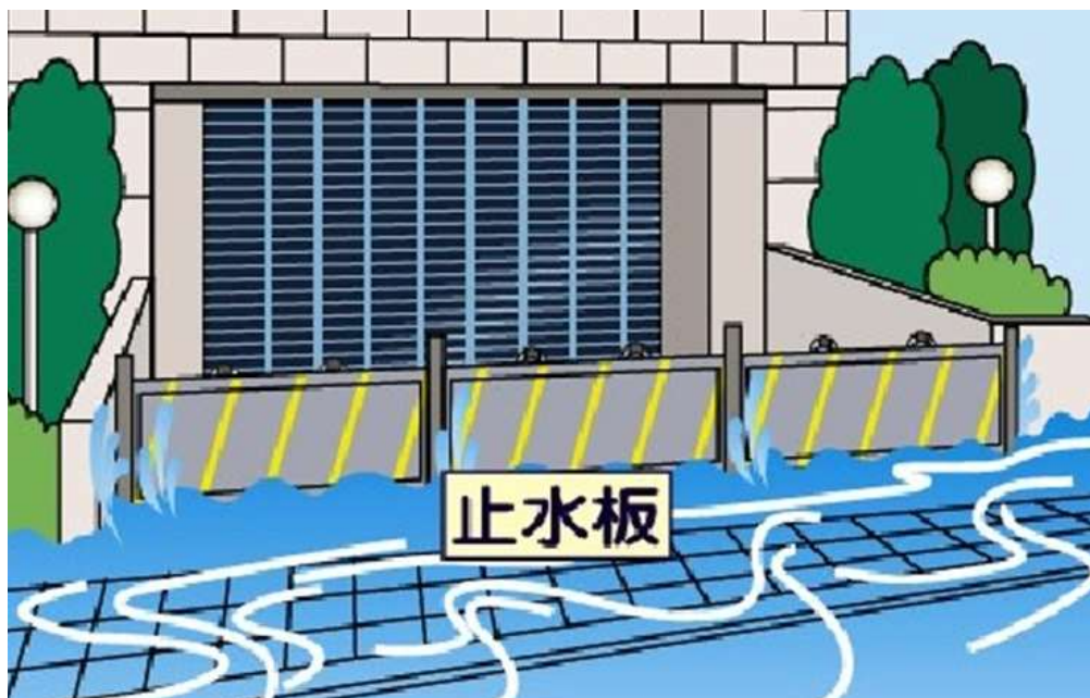
浸水対策の例（止水板の設置）
