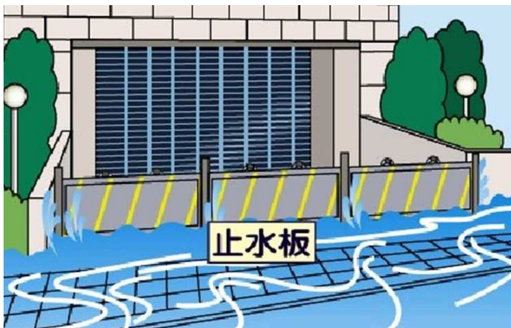
浸水対策の例（止水板の設置）
