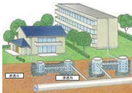
雨水储存渗透设施的设置示意图
